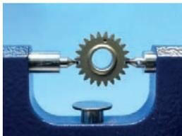
Alle Messkugeln, Messkugeleinsätze und Messrolleneinsätze sind aus Hartmetall um den Verschleiß zu minimieren.
